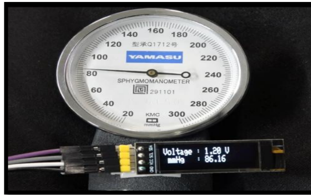
Gambar 4. Pengcalibrasi Sensor MPX5050DP
